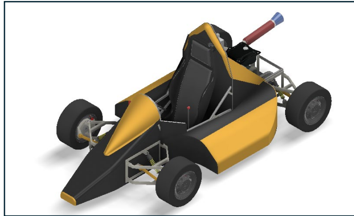
Rajah 3.1: Model rekabentuk kereta lumba ATEC PSMZA tanpa sayap hadapan dan belakang.
