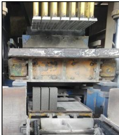
Rajah 2: Mesin Pemampat Dan Sampel Bata Simen Yang Dihasilkan
