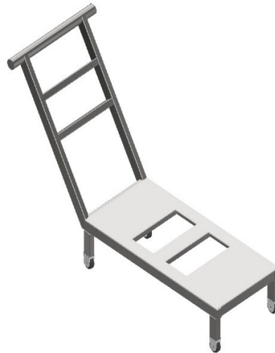
Rajah 3.1: Model reka bentuk alat troli pengangkut bateri buggy elektrik formula elektrik.
