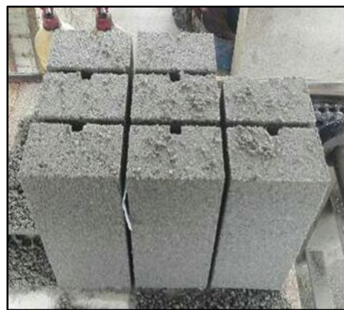
Rajah 2: Mesin Pemampat Dan Sampel Bata Simen Yang Dihasilkan
