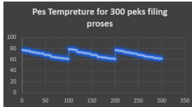
Rajah 2: Graf penurunan suhu pes yang bagi 300 paket semasa proses pengisian
