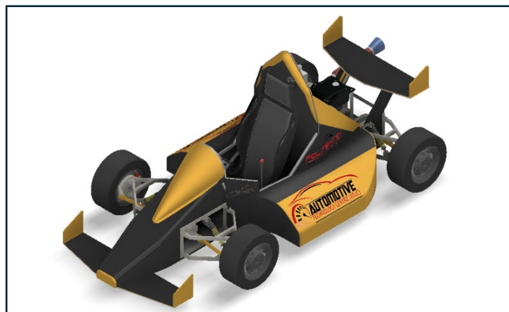
Rajah 3.2: Model rekabentuk kereta lumba ATEC PSMZA dengan sayap hadapan dan belakang.
