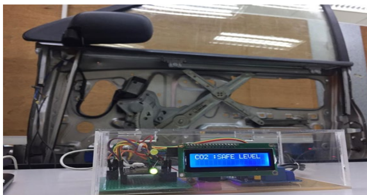
Rajah 3: Paparan LCD dengan kadar CO 2 “SAFE LEVEL”.
