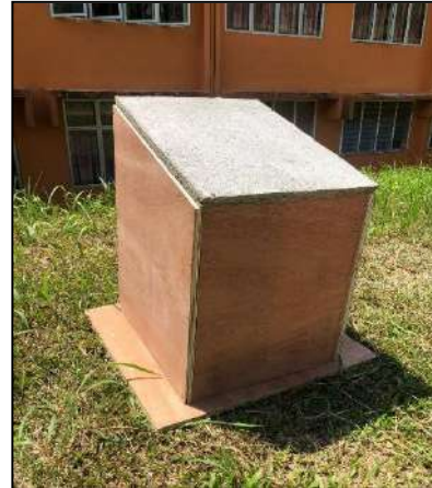
Rajah 4: Ujian resapan haba dijalankan terhadap atap genting biasa dan atap genting campuran sabut
