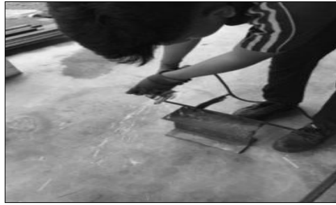
Rajah 9: Proses Memotong Besi Untuk Pemijak Kaki dan Tiang Alat Inovasi
