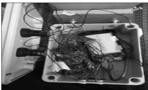
Rajah 8: Proses Pemasangan Komponen Sensor dan Arduino Ke Dalam Kotak Elektrik Berserta Panel Solar Pada Bahagian Atas.
