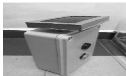
Rajah 8: Proses Pemasangan Komponen Sensor dan Arduino Ke Dalam Kotak Elektrik Berserta Panel Solar Pada Bahagian Atas.
