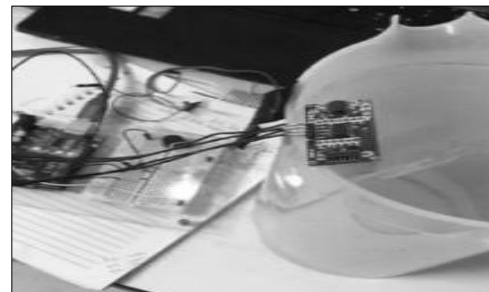
Rajah 7: Proses Pengkodan dan Ujian Awal Terhadap Sensor dan Arduino.
