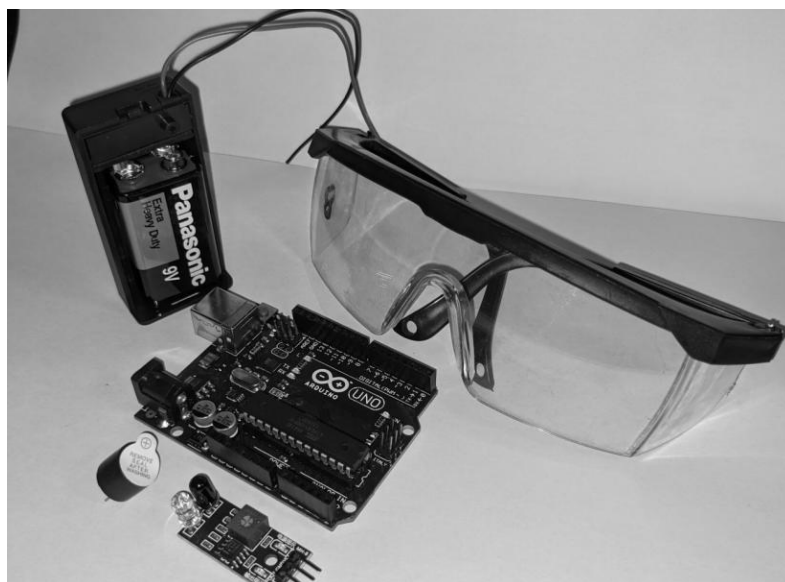
Rajah 6: Komponen utama iaitu Arduino Uno, Sensor pegasan halangan, buzzer, bateri dan kaca mata
